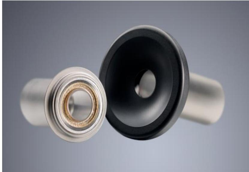
Lasergeschweisstes Okular eines medizinischen Endoskops von KARL STORZ SE & Co. KG; hergestellt mit einem faserbasierten Festkörperlaser TruFiber 500 in einer TruLaser Station 7000 (in mobiler Roboterzelle von wbt automation).
